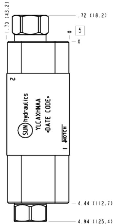
Diese Ventilkombination beinhaltet eine in Ruhestellung geöffnete 2-Wege Druckwaage im Anschluss A. Sie hat die Funktion, die Druckdifferenz über das Wegeventil konstant zu halten und hohe Strömungskräfte am Ventilschieber zu eliminieren. Man erreicht das durch Drosselung des Ablaufes in A. Die daraus resultierende, gleich bleibende Druckdifferenz macht aus dem Proportional Wegeventil einen Proportional Stromregler.
