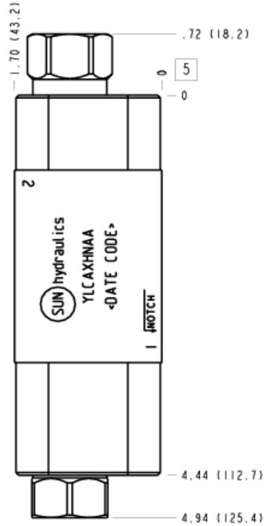
Cet ensemble consiste en un compensateur normalement ouvert de type 2 voies sur l'orifice A. Sa fonction est de maintenir une perte de charge relativement constante au travers du distributeur, isolant ainsi le tiroir des importantes forces parasites dues au flux. Ceci est réalisé en étranglant le retour de l'orifice A. La perte de charge constante crée une régulation du débit compensée en pression en sortie du distributeur.
