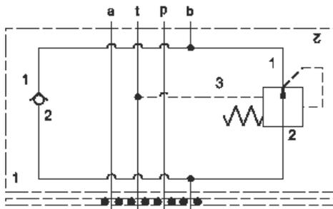
Diese Ventilkombination beinhaltet eine in Ruhestellung geöffnete 2-Wege Druckwaage im Anschluss B. Sie hat die Funktion, die Druckdifferenz über das Wegeventil konstant zu halten und hohe Strömungskräfte am Ventilschieber zu eliminieren. Man erreicht das durch Drosselung des Ablaufes in B. Die daraus resultierende, gleich bleibende Druckdifferenz macht aus dem Proportional Wegeventil einen Proportional Stromregler.
