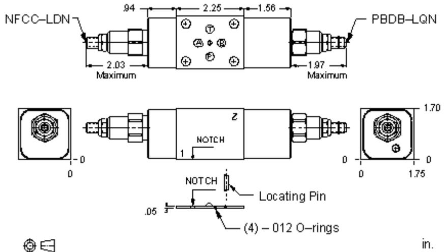
Cet ensemble consiste en une réduction de pression pilotée, qui réduit une pression élevée en amont (orifice P) en une pression réduite constante en aval. De plus cet ensemble fournit un contrôle de la vitesse via un limiteur de débit pleine plage, depuis les orifices A et B vers le T. Cet ensemble peut être utilisé comme amortissement sur le tiroir principal quand il est monté sur un distributeur CETOP à action pilotée, entre le pilote CETOP 3 et l'étage de puissance.
