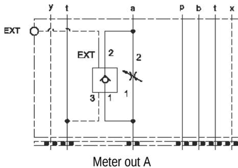
Diese Baugruppe enthält eine Drossel mit voll verstellbarer Blende, mit der Volumenströme reguliert werden können. Die Blende kann frei verstellt werden von vollständig geschlossen bis zum maximalen Blendendurchmesser. Die Drossel ist nicht druckkompensiert. Sie kann zum Einstellen von Volumenströmen oder als Absperrventil benutzt werden. Die Vorschubrate wird mit einem entlasteten, entsperrenen Rückschlagventil mit externem Steueranschluss ausgewählt.
