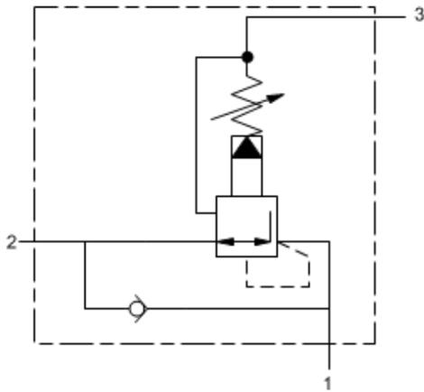
Cet ensemble consiste en un réducteur de pression piloté à 3 voies qui réduit la pression primaire élevée de l'entrée (orifice 2) en une pression réduite constante dans la chambre 1, et fonctionne en limiteur de pression capable du plein débit de la chambre 1 vers le réservoir (chambre 3). Un clapet anti-retour permet le passage en sens inverse de la chambre 1 vers la 2.
