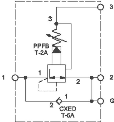
Cet ensemble consiste en un réducteur de pression piloté à 3 voies qui réduit la pression primaire élevée de l'entrée (orifice 2) en une pression réduite constante dans la chambre 1, et fonctionne en limiteur de pression capable du plein débit de la chambre 1 vers le réservoir (chambre 3). Un clapet anti-retour permet le passage en sens inverse de la chambre 1 vers la 2.
