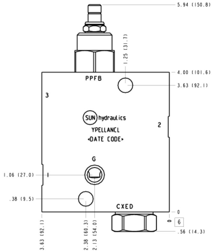
Diese Baugruppe besteht aus einem vorgesteuerten 3-Wege-Druckregelventil. Der hohe Primärdruck am Einlass (Anschluss 2) wird auf einen konstanten Druck am Anschluss 1 reduziert, mit einer Druckbegrenzungsfunktion vom Anschluss 1 zum Tank (Anschluss 3). Ein Umgehungs Rückschlagventil erlaubt freien Durchfluss von Anschluss 1 nach 2.
