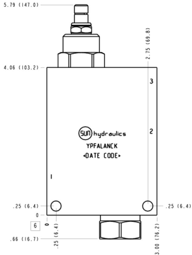
Cet ensemble consiste en un réducteur de pression piloté qui réduit la pression primaire élevée de l'entrée (chambre 2) en une pression réduite constante dans la chambre 1. Un clapet anti-retour permet un passage libre en sens inverse de l'orifice 1 vers l'orifice 2. L'orifice 3 est le drain.
