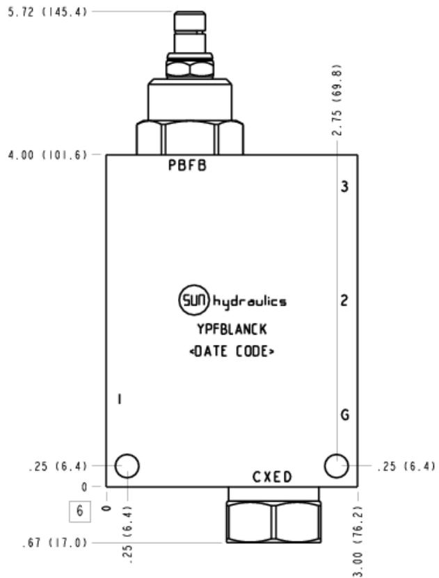
Cet ensemble consiste en un réducteur de pression piloté à 3 voies qui réduit la pression primaire élevée de l'entrée (orifice 2) en une pression réduite constante dans la chambre 1, et fonctionne en limiteur de pression capable du plein débit de la chambre 1 vers le réservoir (chambre 3). Un clapet anti-retour permet le passage en sens inverse de la chambre 1 vers la 2.
