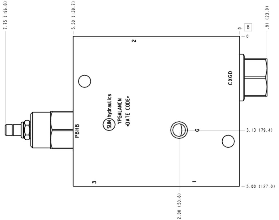
Cet ensemble consiste en une réduction de pression pilotée, qui réduit une pression élevée en entrée (orifice 2) en une pression réduite constante en aval (orifice 1). De plus, cet ensemble est doté d'un clapet qui permet un passage libre de l'orifice 1 vers le 2.
