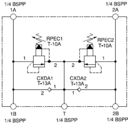
Cet ensemble procure une double limitation de pression à décharges croisées, et une protection contre la cavitation entre les orifices 1 et 2.
