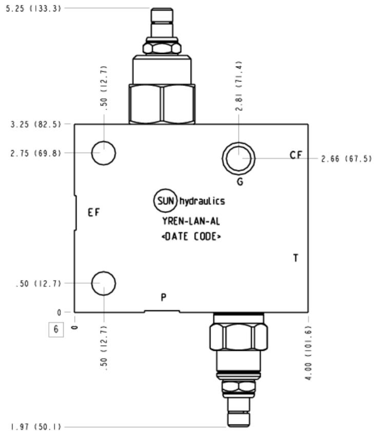
Diese Baugruppe enthält einen 3-Wege Vorzugsstromregler mit Festblende. Anschluss P ist der Einlass und Anschluss CF (Controlled Flow) der geregelte Auslass. Wenn die Bedingungen für den Vorzugsstrom erfüllt sind, wird der überschüssige Volumenstrom zum Anschluss EF (Excessive Flow) umgeleitet. Dieser Bypassvolumenstrom kann in einem zweiten Kreis genutzt werden. Ein Druckbegrenzungsventil schützt den geregelten Auslass gegen Überdruck und entlastet CF nach T.
