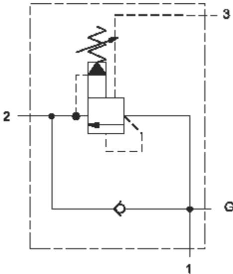
Diese Baugruppe besteht aus einem 2 bar Rückschlagventil und einem vorgesteuerten Druckbegrenzungsventil. Es ist ein in Ruhestellung geschlossenes Steuerelement mit druckausgeglichenem Hauptkolben. Wenn der Druck P (Anschluss 1) den Einstellwert des Ventils überschreitet, wird der überschüssige Druck zum Tank (Anschluss 2) entlastet. Die Ventile sind genau, Druckanstieg über Volumenstrom ist gering, sie arbeiten stabil und ruhig und sind moderat schnell.
