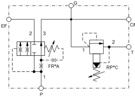
Diese Baugruppe enthält einen 3-Wege Vorzugsstromregler mit Festblende. Anschluss P ist der Einlass und Anschluss CF (Controlled Flow) der geregelte Auslass. Wenn die Bedingungen für den Vorzugsstrom erfüllt sind, wird der überschüssige Volumenstrom zum Anschluss EF (Excessive Flow) umgeleitet. Dieser Bypassvolumenstrom kann in einem zweiten Kreis genutzt werden. Ein Druckbegrenzungsventil schützt den geregelten Auslass gegen Überdruck und entlastet CF nach T.
