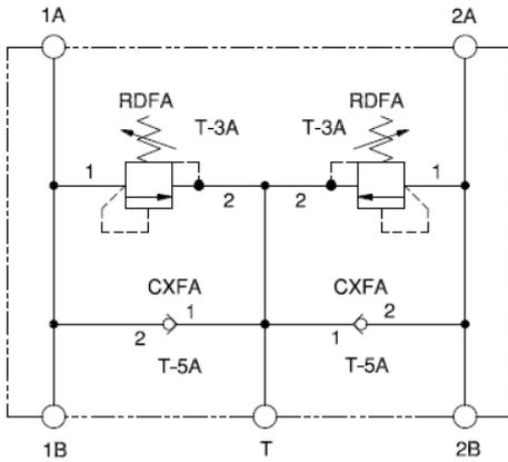
Cet ensemble procure une double limitation de pression à décharges croisées, et une protection contre la cavitation entre les orifices 1 et 2.
