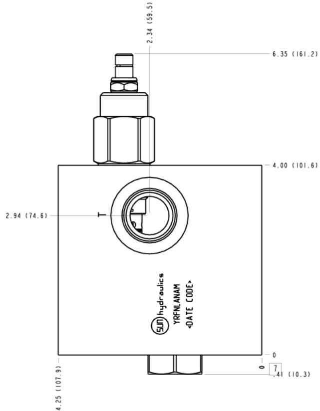
Cet ensemble assure 2 fonctions. Il comporte 2 limiteurs de pression à décharges croisées entre les orifices M1 et M2. Il offre aussi une protection anti-cavitation pour les orifices M1 et M2.
