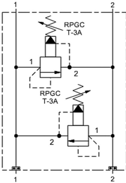
Diese Baugruppe enthält Doppelschockventile zwischen den Anschlüssen 1 und 2.
