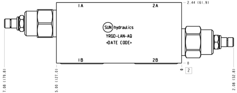
Diese Baugruppe enthält Doppelschockventile zwischen den Anschlüssen 1 und 2.
