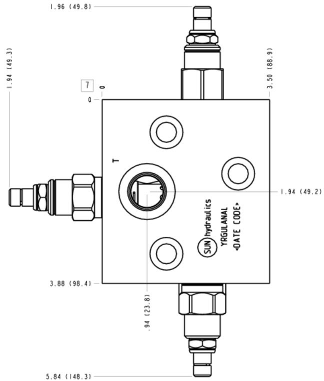
In dieser Ventilkombination sind Doppelschockabsicherung und Spülkreisbeschaltung für geschlossene, hydrostatische Antriebe integriert. Der Spülkreis lässt heißes und ggf. verschmutztes Öl auf der Niederdruckseite ablaufen, während dieser Verlust über eine separate Spülpumpe wieder ausgeglichen wird.
