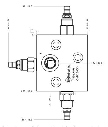
Ce bloc protège les lignes haute pression des transmissions hydrostatiques avec des limiteurs à décharge croisée, et fournit un débit de rinçage. Le débit de rinçage permet d'évacuer de l'huile chaude depuis la ligne basse pression du circuit fermé. La pompe de gavage remplace l'huile chaude et polluée par de l'huile froide et filtrée. L'huile évacuée est également souvent utilisée pour traverser les carters de pompe et de moteur, les rinçant aussi de leur huile chaude et polluée.
