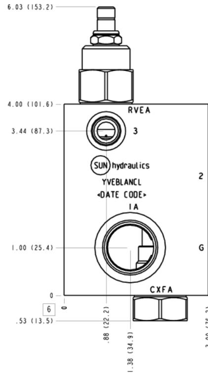
Diese Baugruppe hat zwei Funktionen. Sie begrenzt den Druck am Anschluss 1 zum Tank, wenn der Druck an 1 die Einstellung überschreitet. Der externe Anschluss 3 erlaubt eine Entlastung des Ventils über ein externes 2/2-Wegeventil. Der Druck kann so auf einen Minimalwert abgesenkt werden. Das externe Ventil kann entweder im Ruhezustand offen oder geschlossen sein. Ein Umgehungsrückschlagventil erlaubt einen Rückstrom von Anschluss 2 nach 1.
