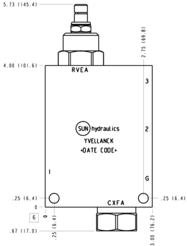
Diese Baugruppe besteht aus einem 2 bar Rückschlagventil und einem vorgesteuerten Druckbegrenzungsventil. Es ist ein in Ruhestellung geschlossenes Steuerelement mit druckausgeglichenem Hauptkolben. Wenn der Druck P (Anschluss 1) den Einstellwert des Ventils überschreitet, wird der überschüssige Druck zum Tank (Anschluss 2) entlastet. Die Ventile sind genau, Druckanstieg über Volumenstrom ist gering, sie arbeiten stabil und ruhig und sind moderat schnell.
